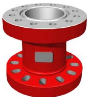
Катушка переходная предназначена для работы в составе противовыбросового оборудования при текущем и капитальном ремонте скважин. Условия эксплуатации — в умеренном и холодном климатических районах по ГОСТ16350 при температуре окружающего воздуха от  $-50^{\circ}$  до  $+50^{\circ}$ .
