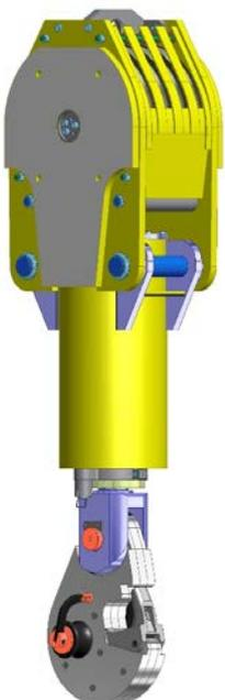
Крюкоблок предназначен для подвешивания при помощи штропов с элеватором бурильных и обсадных труб, вертлюгов, а также для подъема, спуска и подтаскивания вспомогательных грузов при бурении и монтажно-демонтажных работ. Крюкоблок представляет собой совмещение конструкции талевого блока и крюка.
